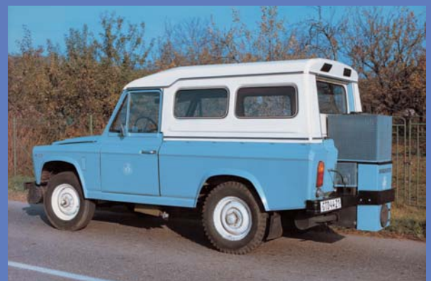
Gaz s generátorem DOKOGEN 1985
